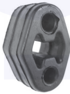
SUPPORTO tubo scarico
