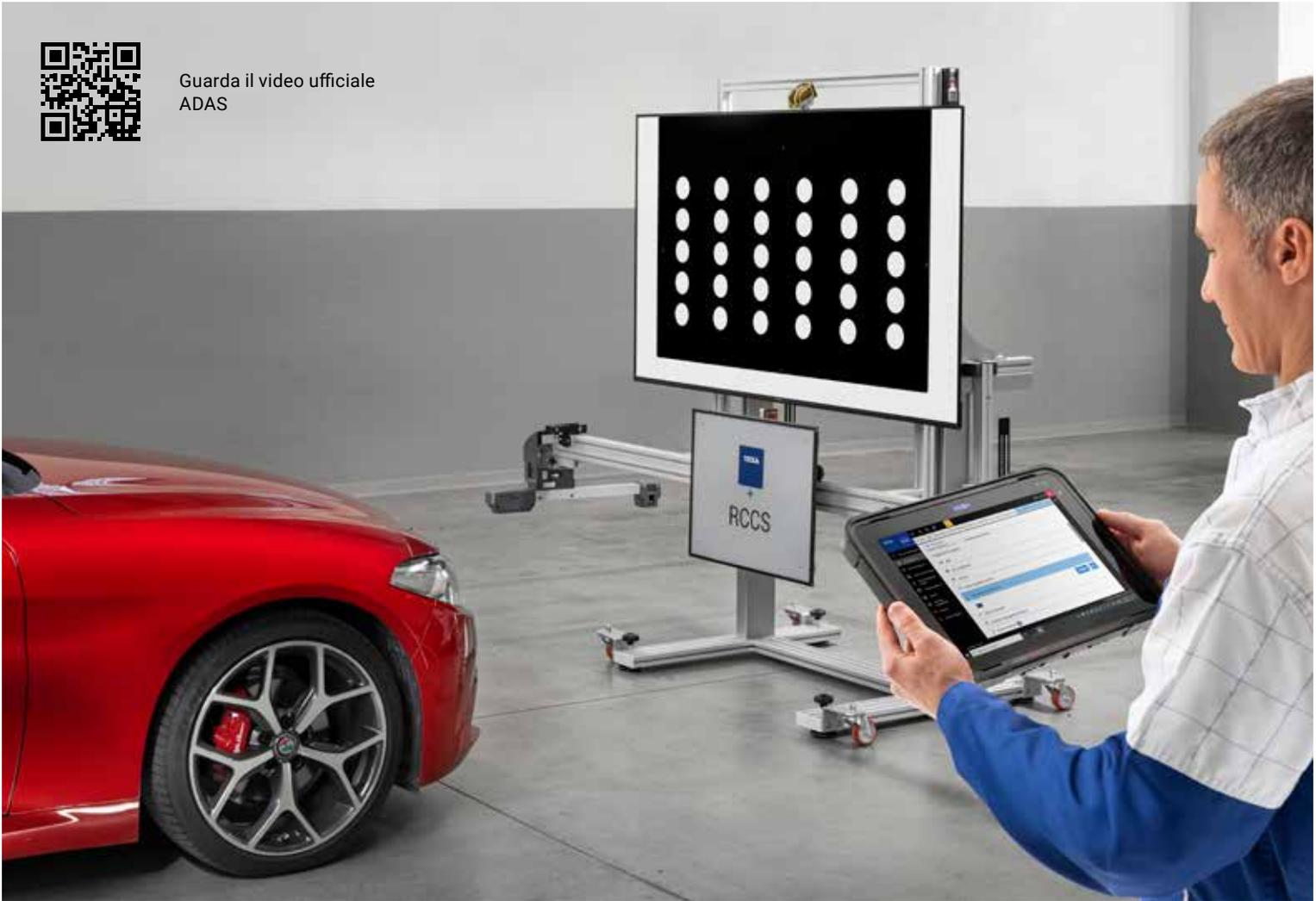
Per la calibrazione di radar, lidar, telecamere e sensori TEXA ha progettato e ingegnerizzato **RCCS 3**, una soluzione top di gamma **disponibile in due versioni**: RCCS 3 con **Monitor** e RCCS 3 con **Pannelli**.
